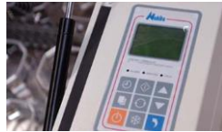
[01] Display para el control de la velocidad, temperatura y tiempo. Display to program the operation speed, temperature and time
